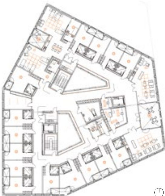
Alterszentrum Appenzell, Grundriss 3. OG, Mst. ca. 1:750 mit dynamischen Lichtdecken in den Aufenthaltsräumen (rechts), in der Pflegeoase (links) sowie dynamischen Einzelleuchten im Stationszimmer (Mitte).
