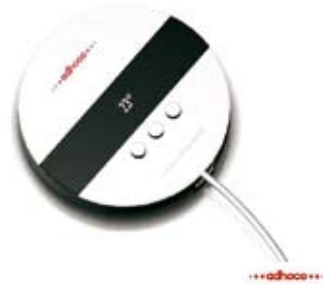
Knapp so gross wie eine Handfläche und nur mit einem Ethernetanschluss mit integrierter Speisung ausgerüstet: So präsentiert sich die «Zentrale» von «aFrame».
